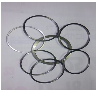
幅広クイック爪®で薄肉リングを加工しました
