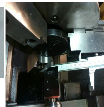
PLVを取付、爪寸法を測定
